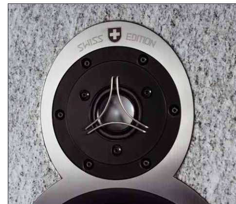
Die Berylliumkalotte ist ab Werk schon gut vor Fremdeinwirkung geschützt, was bei ihrer Klasse und vor allem ihrem Preis auch Sinn macht
